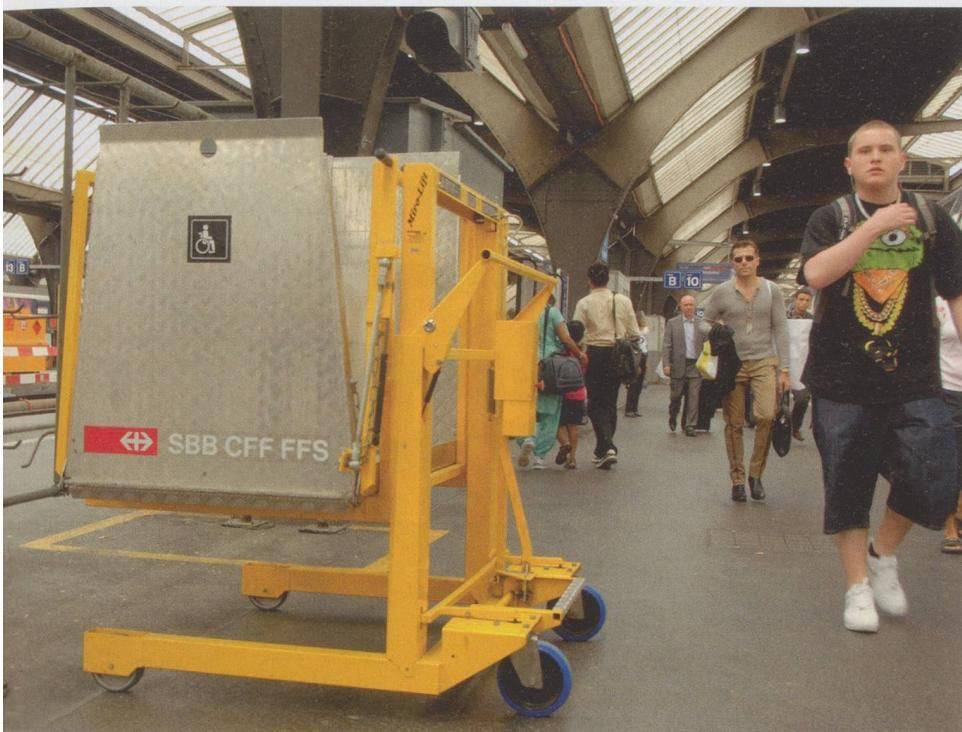
Das Angebot an Niederflurfahrzeugen wurde in den letzten Jahren markant ausgebaut. Wo noch älteres Rollmaterial im Einsatz ist, werden Menschen, die auf einen Rollstuhl angewiesen sind, mit einem Lift in den Zug befördert.
