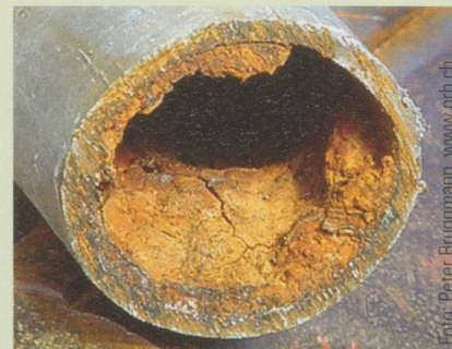
Derart verkrustete Rohre sind keine Seltenheit, sie bilden die Ursache für Druckabfall und Rostwasser.
