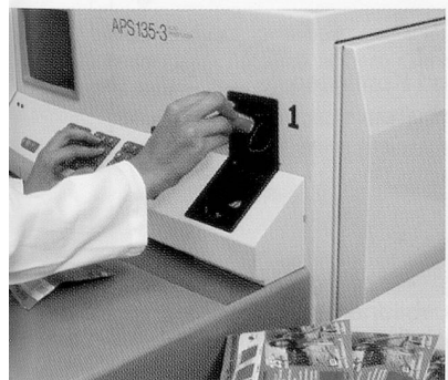
Die Filme werden für die Weiterverarbeitung zusammengespleist.
