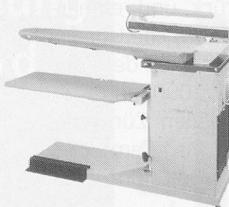
Tischblatthöhe verstellbar von 80–95 cm, rostfreies Tischblatt (XL 125 x 50 x 23 cm), thermostatgeregelter Tischblatt-Temperatur, Dampfabsaug-Ventilator auf breiter Fussleiste steuerbar, Absaugspalte des Tischblattes beim Arbeiten mit dem Ärmelbügler, Abstellfläche für Dampfbügeleisen, Auffangtuch für Bügelgut
