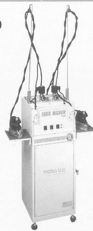
Mit eingebautem Dampferzeuger aus rostfreiem Stahl (5 l), elektronische Niveauregelung, Speisewasserpumpe, Dampfdruckregler, Überdruck-Sicherheitsventil, Abschlemmhähnen, 2 Dampfbügeleisen Swiss-Matic Typ B oder BMS, Speisewassergefäß aus rostfreiem Stahl (10 l), Gerät auf Untersatz mit vier Lenkrollen
