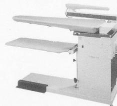
Tischblatthöhe verstellbar von 80–95 cm, rostfreies Tischblatt (XL 125 x 50 x 23 cm), thermostatgeregelter Tischblatt-Temperatur, Dampfabsaug-Ventilator auf breiter Fussleiste steuerbar, Absaugsperrre des Tischblattes beim Arbeiten mit dem Ärmelbügler, Abstellfläche für Dampfbügeleisen, Auffangtuch für Bügelgut
