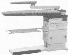
Tischblatthöhe verstellbar von 74–92 cm, rostfreies Tischblatt (XL 125 x 50 x 23 cm), thermostatgeregelter Tischblatt-Temperatur, einfaches Umstellen von Blasen auf Saugen mit Fußpedalsteuerung, Absaugsperrre des Tischblattes beim Arbeiten mit dem Ärmelbügler, Abstellfläche für Dampfbügeleisen, Auffangtuch für Bügelgut, zwei Rollen hinten am Tisch montiert – für einfache Verschiebung
