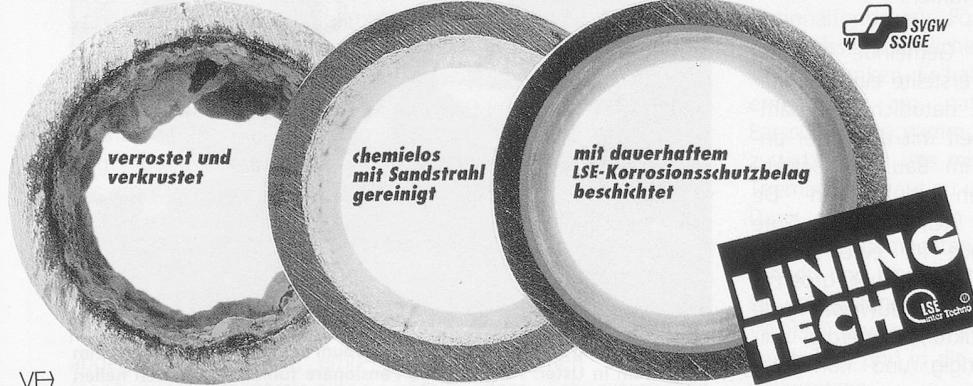
**LINING TECH AG** saniert seit über 12 Jahren mit dem LSE-System und hat als ältestes Unternehmen für Rohr-Innensanierung grösste Erfahrung. Für die Dauerhaftigkeit bestätigt das LPM-Labor Beinwil eine unveränderte Qualität des LSE-Korrosionsschutzbelags in Rohren, welche über 10 Jahre im Einsatz waren. Die geprüften Rohrstücke stammen aus verschiedenen Objekten, die Lining Tech damals sanierte. Diese Sicherheit für die Dauerhaftigkeit der Sanierung kann nur Lining Tech bieten.
