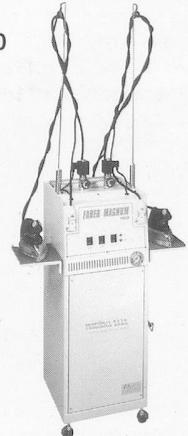
Mit eingebautem Dampferzeuger aus rostfreiem Stahl (5 l), elektronische Niveauregler, Speisewasserpumpe, Dampfdruckregler, Überdruck-Sicherheitsventil, Abschleimhahnen, 2 Dampfbügeleisen Swiss-Matic Typ B oder BMS, Speisewassergefäß aus rostfreiem Stahl (10 l), Gerät auf Untersatz mit vier Lenkrollen
