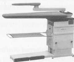
Tischblatthöhe verstellbar von 74–92 cm, rostfreies Tischblatt (XL 125 x 50 x 23 cm), thermostatgeregelter Tischblatt-Temperatur, einfaches Umstellen von Blasen auf Saugen mit Fußspedalleiste, Absaugsperrre des Tischblattes beim Arbeiten mit dem Ärmelbügler, Abstellfläche für Dampfbügeleisen, Auffangtuch für Bügelgut, zwei Rollen hinten am Tisch montiert – für einfache Verschiebung
