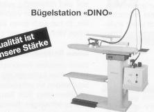
Kompakt, platzsparend Masse total: 135 x 40 x 88 cm, thermostatgeregelte Tischblatt-Temperatur, Dampfabsaug-Ventilator auf breiter Fussleiste steuerbar, Auffangtuch für Bügelgut, Bügeleisen-Untersatz aus Silikongummi (Midi Plus mit Swiss-Vap 5)
