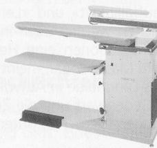
Tischblathöhe verstellbar von 80–95 cm, rostfreies Tischblatt (XL 125 x 50 x 23 cm), thermostatgeregelter Tischblatt-Temperatur, Dampfabsaug-Ventilator auf breiter Fussleiste steuerbar, Absaugsperrre des Tischblattes beim Arbeiten mit dem Ärmelbügler, Abstellfläche für Dampfbügeleisen, Auffangtuch für Bügelgut
