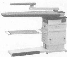
Tischblathöhe verstellbar von 74-92 cm, rostfreies Tischblatt (XL 125 x 50 x 23 cm), thermostatgeregelte Tischblatt-Temperatur, einfaches Umstellen von Blasen auf Saugen mit Fusspedalleiste, Absaugsperrre des Tischblattes beim Arbeiten mit dem Ärmelbügler, Abstellfläche für Dampfbügeleisen, Auffangtuch für Bügelgut, zwei Rollen hinten am Tisch montiert – für einfache Verschiebung
