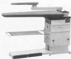
Tischblathöhe verstellbar von 74–92 cm, rostfreies Tischblatt (XL 125 x 50 x 23 cm), thermostatgeregelter Tischblatt-Temperatur, einfaches Umstellen von Blasen auf Saugen mit Fusspedalleiste, Absaugsperrre des Tischblattes beim Arbeiten mit dem Ärmelbügler, Abstellfläche für Dampfbügeleisen, Auffangtuch für Bügelgut, zwei Rollen hinten am Tisch montiert – für einfache Verschiebung
