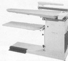
Tischblathöhe verstellbar von 80–95 cm, rostfreies Tischblatt (XL 125 x 50 x 23 cm), thermostatgeregelter Tischblatt-Temperatur, Dampfabsaug-Ventilator auf breiter Fussleiste steuerbar, Absaugsperrre des Tischblattes beim Arbeiten mit dem Ärmelbügler, Abstellfläche für Dampfbügeleisen, Auffangtuch für Bügelgut
