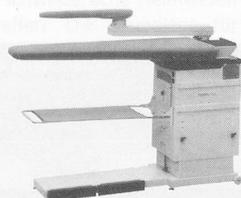
Tischblathöhe verstellbar von 74–92 cm, rostfreies Tischblatt (XL 125 x 50 x 23 cm), thermostatgeregelter Tischblatt-Temperatur, einfaches Umstellen von Blasen auf Saugen mit Fußpedalleiste, Absaugsperrre des Tischblattes beim Arbeiten mit dem Ärmelbügler, Abstellfläche für Dampfbügeleisen, Auffangtuch für Bügelgut, zwei Rollen hinten am Tisch montiert – für einfache Verschiebung
