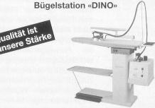
Kompakt, platzsparend Masse total: 135 x 40 x 88 cm, thermostatgeregelte Tischblatt-Temperatur, Dampfabsaug-Ventilator auf breiter Fussleiste steuerbar, Auffangtuch für Bügelgut, Bügeleisen-Untersatz aus Silikongummi (Midi Plus mit Swiss-Vap 5)
