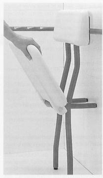
Höhe von 85 bis 90 cm eingehängt werden. Zusätzlich stützt sich der Sitz auf dem Boden ab; dadurch wirken praktisch keine vertikalen Kräfte am Handlauf oder an dessen Befestigungen. Der hochklappbare Sitz kann in der Höhe von 46 bis 53 cm eingestellt werden. Sitz- und Rückenlehne sind gepolstert.
