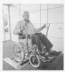
Der «3R-Unimat» funktioniert wie eine automatische Fussmatte für Rollstuhlfahrende. Zu ebener Erde eingelassen oder mit zwei Rampen versehen, reinigen zwei breite, mit rotierenden Bürsten bestückte Walzen die Reifen des Rollstuhls von allen Verunreinigungen. Der vollautomatische Apparat, der den Schmutz in seinem Inneren sammelt,
