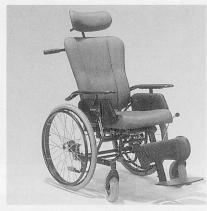
Verschiedene Rahmenhöhen von 39 bis 47 cm sind je nachdem mit 12½-, 20-oder 24-Zoll-Hinterrädern ausgerüstet. Sie sind mit einer mechanisch einstellbaren Rückenlehne, einer Sitzwinkeleinstellung mittels Gasdruckfeder sowie einer betreuergesteuerten Bedienung ausgestattet. Der Sitzwinkel ist stufenlos von 0 bis 20°, die Rückenwinkelverstellung von 90 bis 115° einstellbar.
