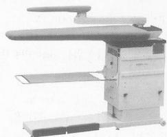
Tischblathöhe verstellbar von 74–92 cm, rostfreies Tischblatt (XL 125 x 50 x 23 cm), thermostatgeregelte Tischblatt-Temperatur, einfaches Umstellen von Blasen auf Saugen mit Fusspedalleiste, Absaugsperrre des Tischblattes beim Arbeiten mit dem Ärmelbügler, Abstellfläche für Dampfbügeleisen, Auffangtuch für Bügelgut, zwei Rollen hinten am Tisch montiert – für einfache Verschiebung
