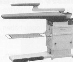
Tischblathöhe verstellbar von 74–92 cm, rostfreies Tischblatt (XL 125 x 50 x 23 cm), thermostatgeregelter Tischblatt-Temperatur, einfaches Umstellen von Blasen auf Saugen mit Fußpedalleiste, Absaugsperrre des Tischblattes beim Arbeiten mit dem Ärmelbügler, Abstellfläche für Dampfbügeleisen, Auffangtuch für Bügelgut, zwei Rollen hinten am Tisch montiert – für einfache Verschiebung
