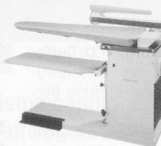
Tischblathöhe verstellbar von 80–95 cm, rostfreies Tischblatt (XL 125 x 50 x 23 cm), thermostatgeregelter Tischblatt-Temperatur, Dampfabsaug-Ventilator auf breiter Fußleiste steuerbar, Absaugsperrre des Tischblattes beim Arbeiten mit dem Ärmelbügler, Abstellfläche für Dampfbügeleisen, Auffangtuch für Bügelgut
