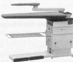
Tischblatthöhe verstellbar von 74–92 cm, rostfreies Tischblatt (XL 125 x 50 x 23 cm), thermostatgeregelte Tischblatt-Temperatur, einfaches Umstellen von Blasen auf Saugen mit Fusspedalleiste, Absaugsperrre des Tischblattes beim Arbeiten mit dem Ärmelbügler, Abstellfläche für Dampfbügeleisen, Auffangtuch für Bügelgut, zwei Rollen hinten am Tisch montiert – für einfache Verschiebung
