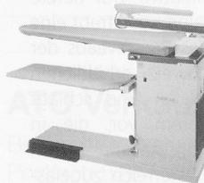
Tischblatthöhe verstellbar von 80–95 cm, rostfreies Tischblatt (XL 125 x 50 x 23 cm), thermostatgeregelte Tischblatt-Temperatur, Dampfabsaug-Ventilator auf breiter Fussleiste steuerbar, Absaugsperrre des Tischblattes beim Arbeiten mit dem Ärmelbügler, Abstellfläche für Dampfbügeleisen, Auffangtuch für Bügelgut
