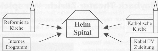
Übertragung von verschiedenen Kirchen od. von einer eigenen Quelle, wie PC, Video, CD, Mikrofon in Ihr bestehendes Netz des Kabelfernsehens.
