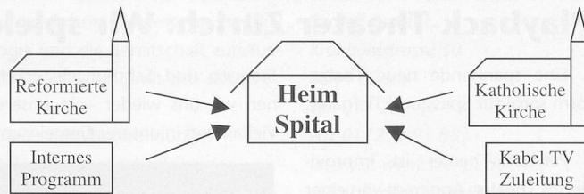
Übertragung von verschiedenen Kirchen od. von einer eigenen Quelle, wie PC, Video, CD, Mikrofon in Ihr bestehendes Netz des Kabelfernsehens. Vorhandene Radio und TV können weiter verwendet werden.
