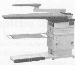
Tischblatthöhe verstellbar von 74–92 cm, rostfreies Tischblatt (XL 125 x 50 x 23 cm), thermostatgeregelter Tischblatt-Temperatur, einfaches Umdrehen von Blasen auf Saugen mit Fußpedalsteuerung, Absaugsperrre des Tischblattes beim Arbeiten mit dem Ärmelbügler, Abstellfläche für Dampfbügeleisen, Auffangtuch für Bügelgut, zwei Rollen hinten am Tisch montiert – für einfache Verschiebung
