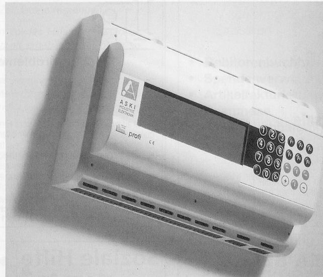
*Das neue Optimatik-Energiekontroll-System «ALS-Profi» verfügt über ein sehr installationsfreundliches Gehäuse, eine einfache Bedienung und über ein übersichtliches Grafikdisplay. Solche Energiekontroll-Systeme eignen sich in allen Branchen, wo Spitzenleistung verrechnet wird.*
