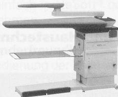
Tischblathöhe verstellbar von 74–92 cm, rostfreies Tischblatt (XL 125 x 50 x 23 cm), thermostatgeregelter Tischblatt-Temperatur, einfaches Umstellen von Blasen auf Saugen mit Fußpedalleiste, Absaugspalte des Tischblattes beim Arbeiten mit dem Ärmelbügler, Abstellfläche für Dampfbügeleisen, Auffangtuch für Bügelgut, zwei Rollen hinten am Tisch montiert – für einfache Verschiebung
