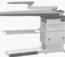
Tischblatthöhe verstellbar von 74–92 cm, rostfreies Tischblatt (XL 125 x 50 x 23 cm), thermostatgeregelter Tischblatt-Temperatur, einfaches Umstellen von Blasen auf Saugen mit Fusspedalleiste, Absaugsperrre des Tischblattes beim Arbeiten mit dem Ärmelbügler, Abstellfläche für Dampfbügeleisen, Auffangtuch für Bügelgut, zwei Rollen hinten am Tisch montiert – für einfache Verschiebung
