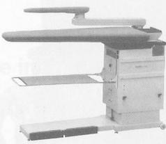
Tischblathöhe verstellbar von 74–92 cm, rostfreies Tischblatt (XL 125 x 50 x 23 cm), thermostatgeregelter Tischblatt-Temperatur, einfaches Umstellen von Blasen auf Saugen mit Fußpedaleiste, Absaugsperrre des Tischblattes beim Arbeiten mit dem Ärmelbügler, Abstellfläche für Dampfbügeleisen, Auffangtuch für Bügelgut, zwei Rollen hinten am Tisch montiert – für einfache Verschiebung
