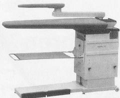
Tischblatthöhe verstellbar von 74–92 cm, rostfreies Tischblatt (XL 125 x 50 x 23 cm), thermostatgeregelte Tischblatt-Temperatur, einfaches Umstellen von Blasen auf Saugen mit Fusspedalleiste, Absaugsperrre des Tischblattes beim Arbeiten mit dem Ärmelbügler, Abstellfläche für Dampfbügeleisen, Auffangtuch für Bügelgut, zwei Rollen hinten am Tisch montiert – für einfache Verschiebung
