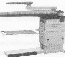
Tischblatthöhe verstellbar von 74–92 cm, rostfreies Tischblatt (XL 125 x 50 x 23 cm), thermostatgeregelter Tischblatt-Temperatur, einfaches Umstellen von Blasen auf Saugen mit Fußpedalleiste, Absaugsperrre des Tischblattes beim Arbeiten mit dem Ärmelbügler, Abstellfläche für Dampfbügeleisen, Auffangtuch für Bügelgut, zwei Rollen hinten am Tisch montiert – für einfache Verschiebung
