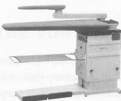
Tischblatthöhe verstellbar von 74–92 cm, rostfreies Tischblatt (XL 125 x 50 x 23 cm), thermostatgeregelter Tischblatt-Temperatur, einfaches Umstellen von Blasen auf Saugen mit Fußpedalleiste, Absaugsperrre des Tischblattes beim Arbeiten mit dem Ärmelbügler, Abstellfläche für Dampfbügeleisen, Auffangtuch für Bügelgut, zwei Rollen hinten am Tisch montiert – für einfache Verschiebung
