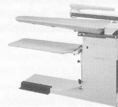
Tischblathöhe verstellbar von 80–95 cm, rostfreies Tischblatt (XL 125 x 50 x 23 cm), thermostatgeregelter Tischblatt-Temperatur, Dampfabsaug-Ventilator auf breiter Fußleiste steuerbar, Absaugspalte des Tischblattes beim Arbeiten mit dem Ärmelbügler, Abstellfläche für Dampfbügeleisen, Auffangtuch für Bügelgut
