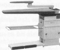
Tischblathöhe verstellbar von 74–92 cm, rostfreies Tischblatt (XL 125 x 50 x 23 cm), thermostatgeregelter Tischblatt-Temperatur, einfaches Umstellen von Blasen auf Saugen mit Fußpedaleiste, Absaugspalte des Tischblattes beim Arbeiten mit dem Ärmelbügler, Abstellfläche für Dampfbügeleisen, Auffangtuch für Bügelgut, zwei Rollen hinten am Tisch montiert – für einfache Verschiebung
