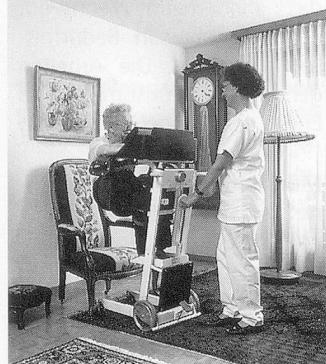
können schmalste Türen passiert werden. Die hinteren grossen Rollen gewährleisten müheloses Fahren auf Teppichen und über Türschwellen, das niedrige Fahrwerk das Unterfahren von Betten.
