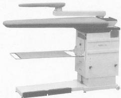
Tischblathöhe verstellbar von 74–92 cm, rostfreies Tischblatt (XL 125 x 50 x 23 cm), thermostattgeregelte Tischblatt-Temperatur, einfaches Umstellen von Blasen auf Saugen mit Fußpedaleiste, Absaugsperrre des Tischblattes beim Arbeiten mit dem Ärmelbügler, Abstellfläche für Dampfbügeleisen, Auffangtuch für Bügelgut, zwei Rollen hinten am Tisch montiert – für einfache Verschiebung
