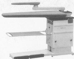
Tischblatthöhe verstellbar von 74–92 cm, rostfreies Tischblatt (XL 125 x 50 x 23 cm), thermostatgeregelte Tischblatt-Temperatur, einfaches Umstellen von Blasen auf Saugen mit Fußpedalleiste, Absaugsperrre des Tischblattes beim Arbeiten mit dem Ärmelbügler, Abstellfläche für Dampfbügeleisen, Auffangtuch für Bügelgut, zwei Rollen hinten am Tisch montiert – für einfache Verschiebung
