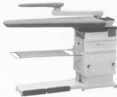
Tischblatthöhe verstellbar von 74–92 cm, rostfreies Tischblatt (XL 125 x 50 x 23 cm), thermostatkugelregelte Tischblatt-Temperatur, einfaches Umstellen von Blasen auf Saugen mit Fußpedalleiste, Absaugsperrre des Tischblattes beim Arbeiten mit dem Ärmelbügler, Abstellfläche für Dampfbügeleisen, Auffangtuch für Bügelgut, zwei Rollen hinten am Tisch montiert – für einfache Verschiebung
