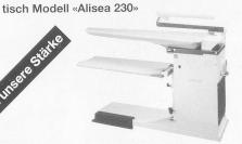
Tischblatthöhe verstellbar von 80-95 cm Rostfreies Tischblatt (XL 125 x 50 x 23 cm) aus ALU-Lochblech – verschraubt mit der Wasser-/ Dampf-Schale aus hochwertigem Kunststoff Thermostatgeregelte Tischblatt-Temperatur Dampfabsaug-Ventilator auf breiter Fussleiste steuerbar Absaugsperre des Tischblattes beim Arbeiten mit dem Ärmelbügler, Abstellfläche für Dampfbügeleisen Auffangtuch für Bügelgut
