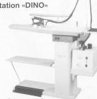
kompakt, platzsparend Masse total: 135 x 40 x 88 cm Thermostatgeregelte Tischblatt-Temperatur • Dampfabsaug-Ventilator auf breiter Fussleiste steuerbar • Auffangtuch für Bügelgut • Bügeleisen-Untersatz aus Silikonaummi
