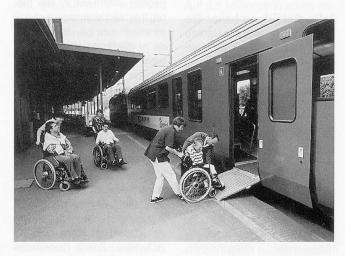
Der neue Niederflurwagen ermöglicht den Rollstuhlfahrerinnen und -fahrern ein selständiges Hinein- und Hinausrollen, dank einer auf drei Perronhöhen (55, 35 und Ocm) einstellbaren, elektrischen Schieberampe. Er ergänzt den seit 1991 in Betrieb stehenden Bahnwagen, der Rollstuhlfahrer mittels einer Hebebühne aufnimmt. Mit dem gestrigen Stapellauf bestätigt die SBB einmal mehr ihr Engagement für behinderte Reisende.
