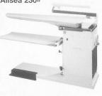
Tischblatthöhe verstellbar von 80-95 cm Rostfreies Tischblatt (XL 125 x 50 x 23 cm) aus ALU-Lochblech - verschraubt mit der Wasser-/ Dampf-Schale aus hochwertigem Kunststoff Thermostatgeregelte Tischblatt-Temperatur Dampfabsaug-Ventilator auf breiter Fussleiste steuerbar Absaugsperre des Tischblattes beim Arbeiten mit dem Ärmelbügler, Abstellfläche für Dampfbügeleisen Auffangtuch für Bügelgut
