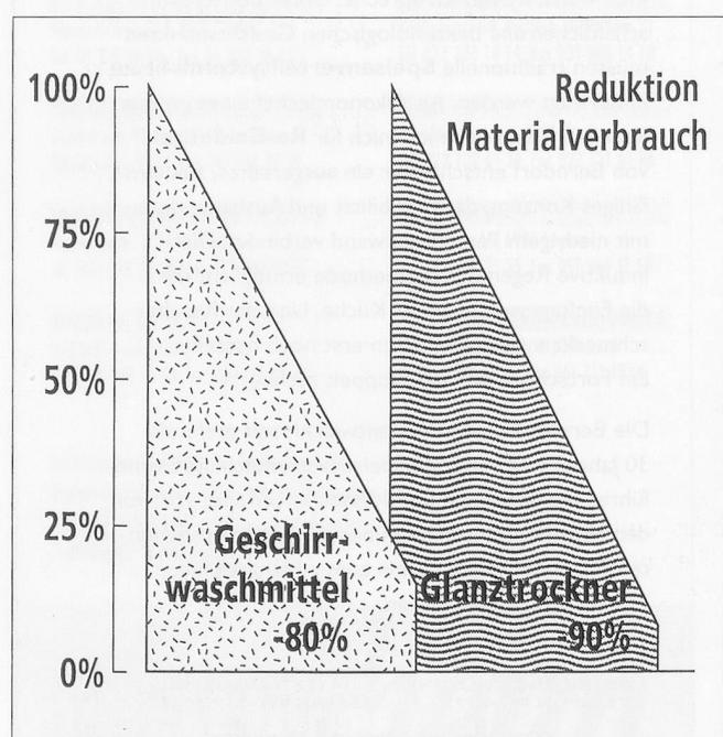
Der Einsatz einer Gegenosmose-Anlage im Gastgewerbe macht sich schnell bezahlt, weil teures Verbrauchsmaterial für den Abwasch massiv reduziert wird und die aufwendige Handarbeit für das Nachpolieren der Gläser entfällt.
