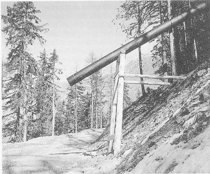
Kein neues Wasserkraftwerk! Die Holzschnitzelleitung zum Laden des Container-Lastwagens führt im freien Fall vom Hackerplatz mit Vorrats-Container zum abgebildeten Ladeplatz. Der Vorrats-Container dient als Zwischenlager zur Verkürzung der Lastwagen-Wartezeiten.
