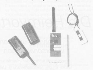
CerHome für massgerechte Sicherheits- und Brandmeldeanlagen im Wohnbereich. Das System umfasst neben Brandmeldern auch drahtgebundene und drahtlose Intrusionsmelder sowie kleine manuelle Nothilfe- und Alarmtaster (man trägt sie immer auf sich), mit denen in jeder Bedrohungslage ein Signal ausgelöst werden kann. Die Aufnahme zeigt eine Auswahl mobiler, drahtloser Melder. (Photo Cerberus)
