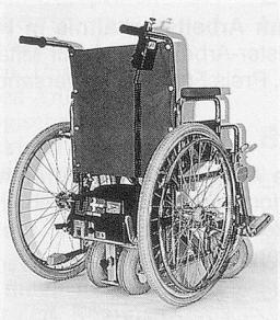
**Modell Power Drive: ideal für die nähere Umgebung.** Mit einer Batterierreichweite von ca. 7 Km, 2-stufige Geschwindigkeit (3 und 5 Km/h), Schiebegriff mit Bediengerät für Geschwindigkeitsregelung (Foto oben Mitte)
