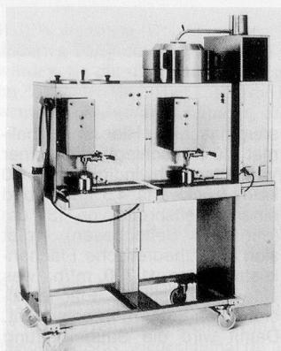
Mit der für die Speiseverteilanlagen konzipierten Modellreihe ist diese Dosierzvorrichtung eine ideale Ergänzung. Der Kaffee oder die Milch gelangen auf dem kürzesten Weg in die Portionenkännchen. Die Verbindung zum Behälterauslauf beträgt nur unge-
