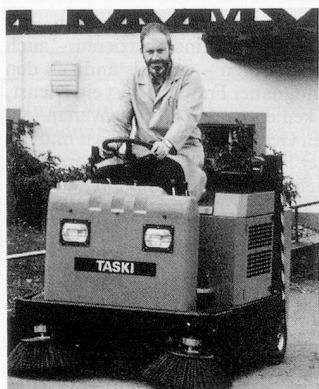
Der TASKI balimat 140 T zeichnet sich – neben den beeindruckenden Leistungszahlen – auch durch die optimale Sitzposition des Fahrers und den minimalen Wendekreis von 194 cm aus. Bei einer Maschine von 168 cm Länge bedeutet dies: Wenden an Ort!
