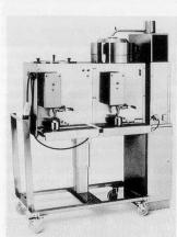
Mit der für die Speiseverteilanlagen konzipierten Modellreihe ist diese Dosiervorrichtung eine ideale Ergänzung. Der Kaffee oder die Milch gelangen auf dem kürzesten Weg in die Portionenkänchen. Die Verbindung zum Behälterauslauf beträgt nur unge-
