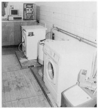
Versuchswaschmaschinen: Während die hintere mit weniger Wasser auskommt – die Wäsche wird mittels Schlauch in der Türe berieselt, die Maschine mit dem Computer im Hintergrund individuell gesteuert –, wäscht der Schulthess-Prototyp vorne nach individuellem Lochkartenprogramm mit weichem Wasser und spült mit hartem. In einer weiteren Phase soll noch mit Seifenflocken gewaschen werden können.
