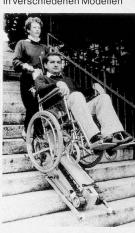
AUER-TREPPENRAUPE, für den sicheren Transport von Rollstuhlfahrern über jede gerade Treppe bis zu 38 Grad Neigung
