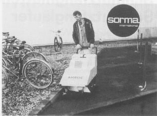
Besonders wendig für freie Flächen und sicher in engen Gängen ist diese neue Kehrmaschine (Amros-500). Mit einer Arbeitsbreite von 600 mm mit Seitenbesen können bereits über 2000 qm/h gekehrt werden. Dabei kann die Maschine wahlweise mit Benzin- oder Elektromotor betrieben werden.
