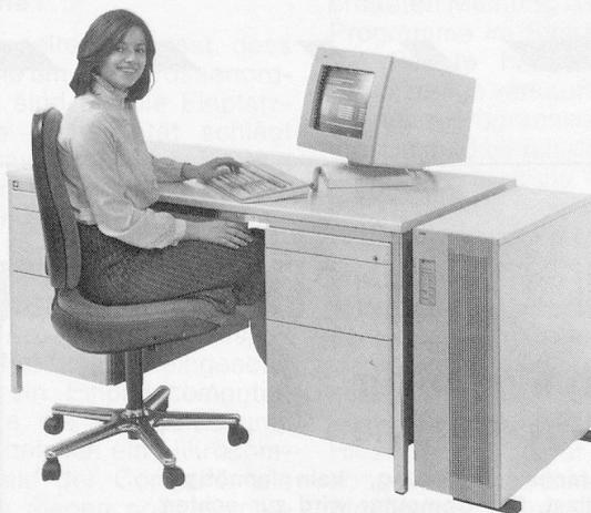
Der neue leistungsstarke NCR 9100 Universal-Computer mit bis 1 MB Memory, Winchesterdisc, Streamertape und Disketten/Kassetten braucht keinen Computerraum. Zusammen mit der ergonomischen Peripherie und der modularen Software aus der umfassenden NCR Softwarebibliothek erhalten Sie damit ein äusserst fortschrittliches Mehrplatzsystem.
