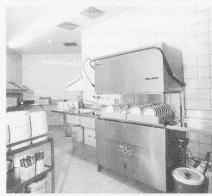
Neu wird eine preisgünstige, kleine, aber leistungsfähige Gläserspülmaschine FV-25 G mit 40 x 40-cm-Körben präsentiert. Automatische Tankfüllung und Türschliessung sind selbstverständlich Zubehör.
