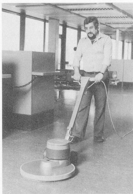
Die hohe Tourenzahl (1000 l/min) erlaubt ein bedeutend schnelleres und mühseloses Arbeiten als mit konventionellen Einscheibenmaschinen. Gleichzeitig wird eine hohe Verdichtung und Verhärtung des Schutzbelaiges erzielt. Dies bedeutet eine geringe Strich- und Schmutzanfälligkeit des Belages einerseits und verlängerte Reinigungsintervalle andererseits.
