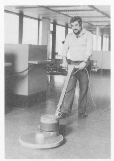
Die Wetrok-Ultraspeed 1050, welche von der Wetrok-Organisation Zürich (Maschinen, Geräte, Produkte und Methoden für die rationelle Gebäudereinigung) entwickelt wurde, ist ideal für die tägliche oder periodische Unterhaltsreinigung von grossen, freien Flächen mit Hartbodenbelägen, wie PVC, Linoleum, Kunststein oder versiegeltem Parkett.
