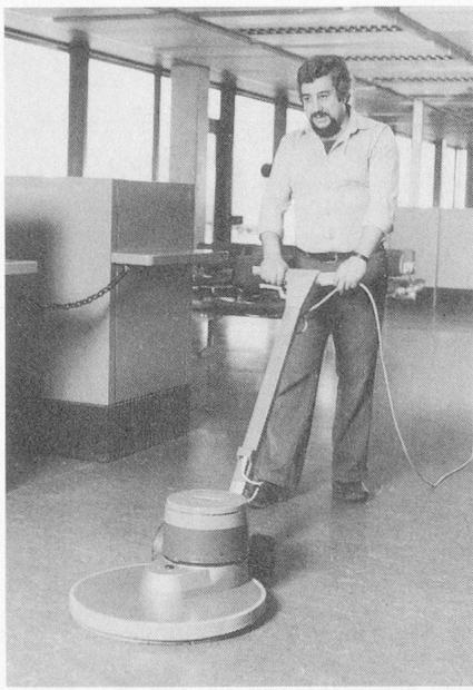
Die hohe Tourenzahl (1000 l/min) erlaubt ein bedeutend schnelleres und müheloseres Arbeiten als mit konventionellen Einscheibenmaschinen. Gleichzeitig wird eine hohe Verdichtung und Verhärtung des Schutzbelaiges erzielt. Dies bedeutet eine geringe Strich- und Schmutzanfälligkeit des Belages einerseits und verlängerte Reinigungsintervalle andererseits.
