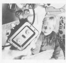
schaltet werden. Sobald ein Geräusch entsteht, schaltet er für eine Zeit von 5 Sek. bis max. 3 Minuten ein. Die Ansprech-Schwelle kann mit einem Drehknopf eingestellt werden, ebenfalls die Einschaltdauer.
