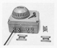
Betriebsspannung 220 V AC oder 12 V=, Sirene, Elektronik, Schlüsselschalter und Schlaufenkontroll-Lampe sind in einem Kunststoffgehäuse von 170 x 130 x 135 mm untergebracht.
