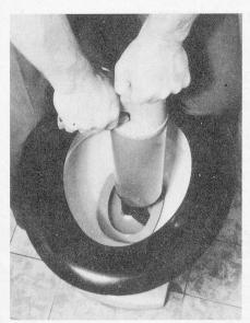
So einfach ist das: Auf der Verstopfung steht das Wasser, das nicht ablaufen kann. Wasser kann man nicht komprimieren. Haut man mit einem Hammer auf die Wassersäule, trifft man automatisch mit der gleichen Wucht den Pfropfen und - fort ist er. Haut sogar Urinstein raus!
