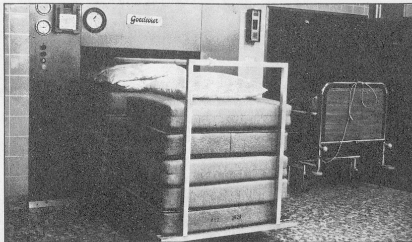
GOEDECKER Bettendesinfektionsanlage inkl. Bettgestellreinigungsanlage. Erhältlich in Grössen von 1 cm 3 –5 cm 3 sowohl in Dreh- als auch in Schiebeturausführung.
