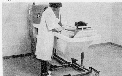
Patient auf der Liegeplatte in der Wanne. Liegeplatte dreiteilig zum Einsatz beiderseits der Wanne.
