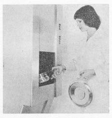
Unter der Apparatebezeichnung SM 20 wird ein neuer Beckenspülapparat gezeigt, welcher in jahrelanger Entwicklung zusammen mit der Firma Merker AG, Baden, entstanden ist.
